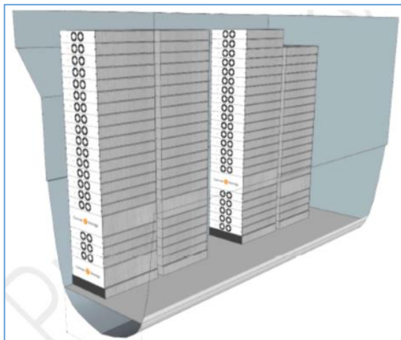
Figure 6, Eksempel på kompakt installasjon i katamaranskrog
